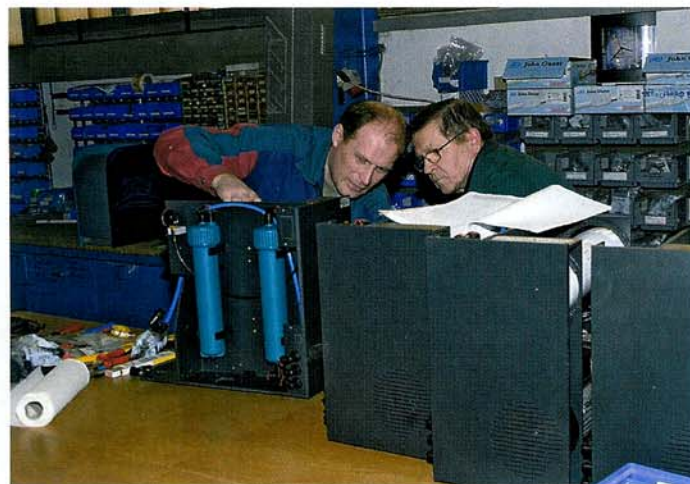
Unten: Hier wird die Komplettanlage Sirius montiert. Rechts: Umkehrosenoseanlagen heutzutage.
