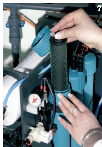
7) Rowa Sirius: particolare del pre-filtro per la filtrazione meccanica delle particelle più grandi. Foto Rowa.
